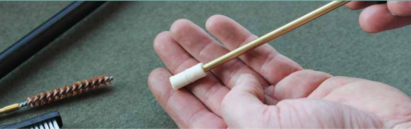
Bei der Reinigung mit den Niebling Reinigungsfilzen haben Sie die Möglichkeit zwei Stück zu verwenden. Der erste wird auf den Halter aufgedreht und damit fixiert, der zweite (vordere) wird aufgesteckt.
